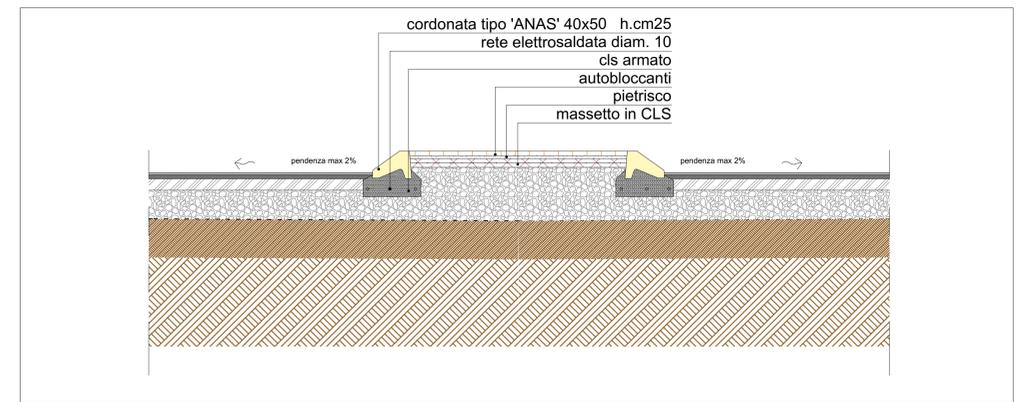
particolare sezione isola spartitraffico rotatoria scala 1\_50
