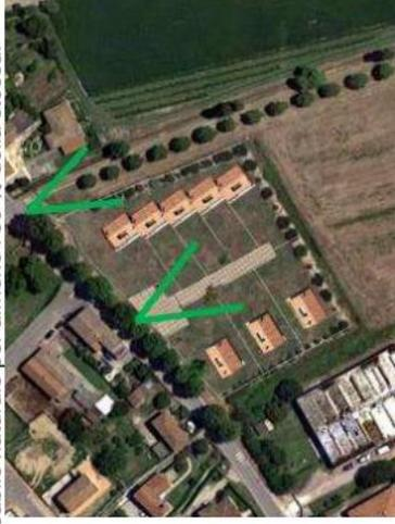
Vanno contenute le opere di urbanizzazione al minimo necessario per garantire l'accessibilità al lotto, con formazione di un parcheggio pubblico di testa in base allo standard minimo di legge per mq 119. L'area scoperta interna al lotto edificabile andrà mantenuta a prato, orto, giardino, con una superficie permeabile naturale per almeno l'80 % della stessa.
